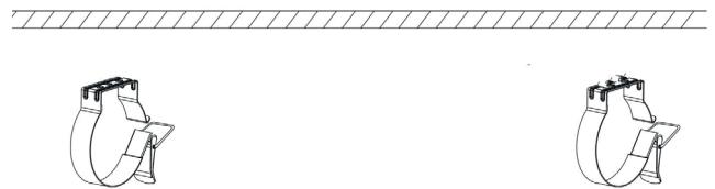
Abb. 3: Montage der Schellen an der Decke
