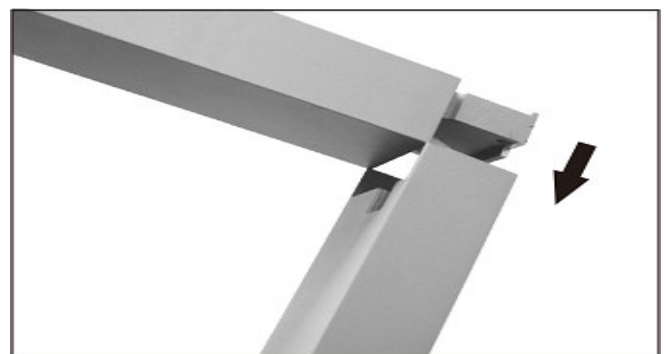
Abb. 6: Winkelstück des Kopfes in die Säule schieben
